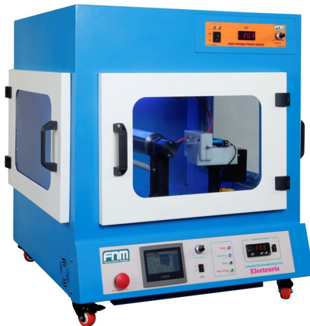
شکل ۴-۱- نمای کلی دستگاه الکتروریس تک پمپ: سیستم ولتاژ بالا، درام جمع‌کننده، بخش کنترل، پمپ سرنگی.
