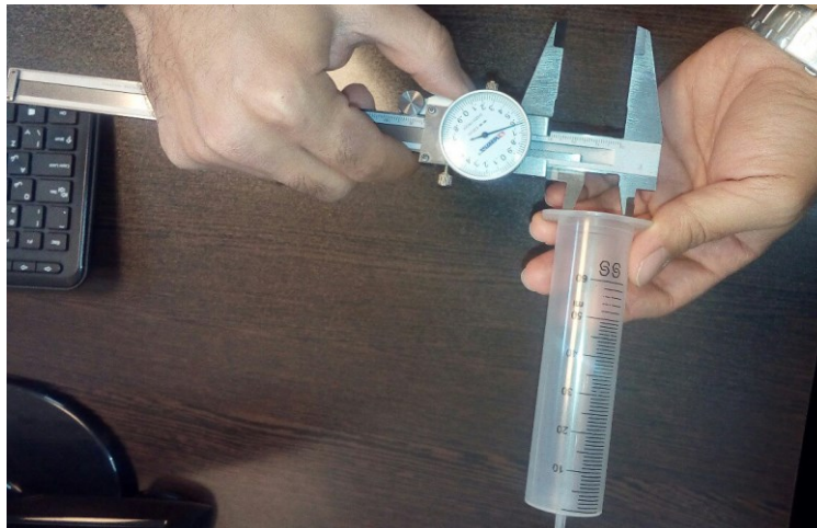
شکل ۴-۲۱- روش صحیح اندازه گیری قطر داخلی سرنگ.
