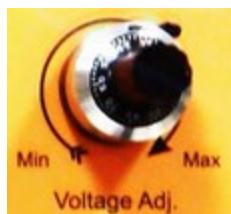
شکل ۴-۱۷- تنظیم کننده ولتاژ (ولوم ۱۰ دور) منبع تامین ولتاژ بالا.
