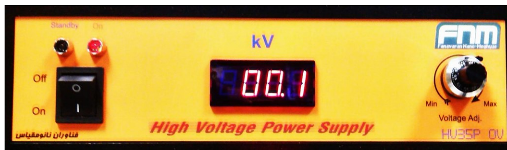
شکل ۴-۱۶- منبع تامین ولتاژ بالای نصب شده بر روی دستگاه الکتروریس (مدل HV35P OV).
